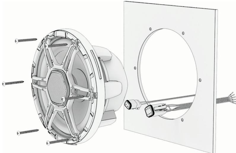
18 Sichern Sie den Lautsprecher mit den mitgelieferten Schrauben an der Montagefläche.
