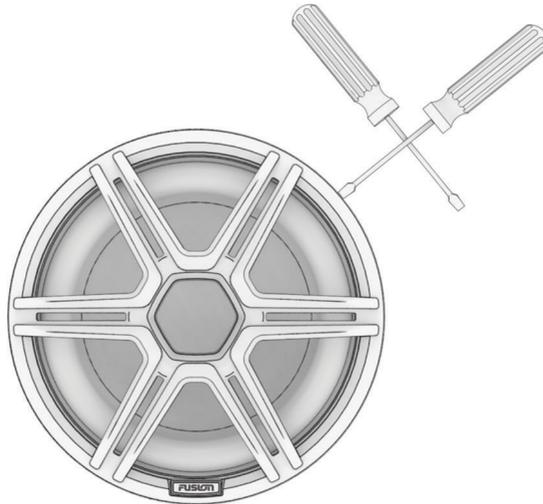
**HINWEIS:** Setzen Sie das Hebelwerkzeug nicht in der Mitte einer Haltetasche an. Der Grill lässt sich einfacher entfernen, wenn Sie an einer der Kanten der Haltetasche beginnen.
