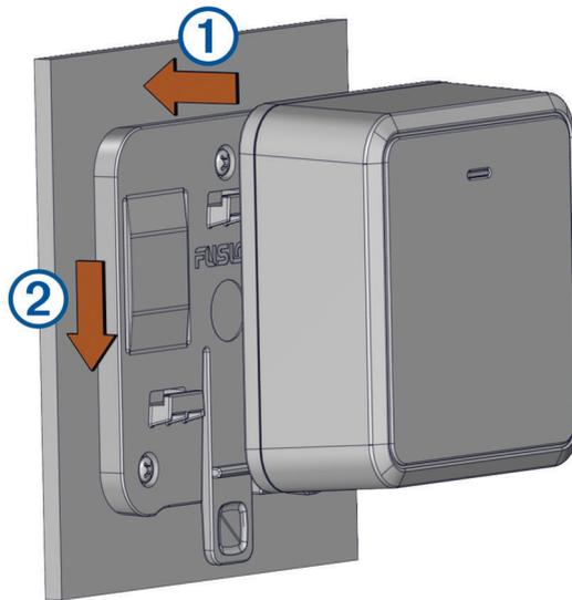
2 Setzen Sie das Gerät in die Halterung ein, und drücken Sie nach unten ②, bis die Verriegelung hörbar einrastet.
